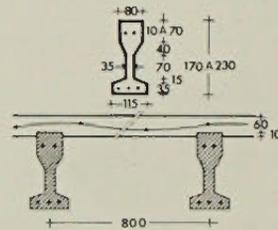
Vigueta normal con sobrelosa hormigonada in sitio formando una losa nervada de hasta 7.00 m. de luz. Es notablemente económica y un 40% más liviana que una losa de hormigón armado tradicional.
