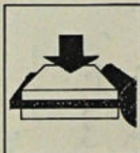
ADVERTENCIA: La compresión deberá efectuarse sobre una superficie a nivel, para evitar que el Compriband se tuerza o enrolle y resulten así variaciones en el ancho.
