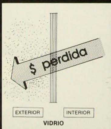
"VIDROPAR" (m.r.) de Digosa es un conjunto formado por dos planchas de vidrio separadas por una cámara de aire quieto y deshidratado. El espacio entre los dos vidrios está definido por un separador de aluminio anodizado, en cuyo interior se introduce el producto deshidratante, quedando la hermeticidad asegurada por un doble sellado perimetral.
